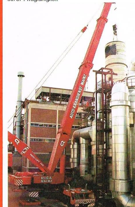
GOTTWALD AMK 400-93, 400/500 t Tragfähigkeit
