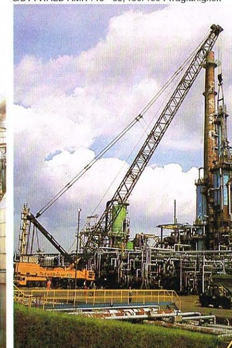
GOTTWALD AK 850, 800/850 t Tragfähigkeit
