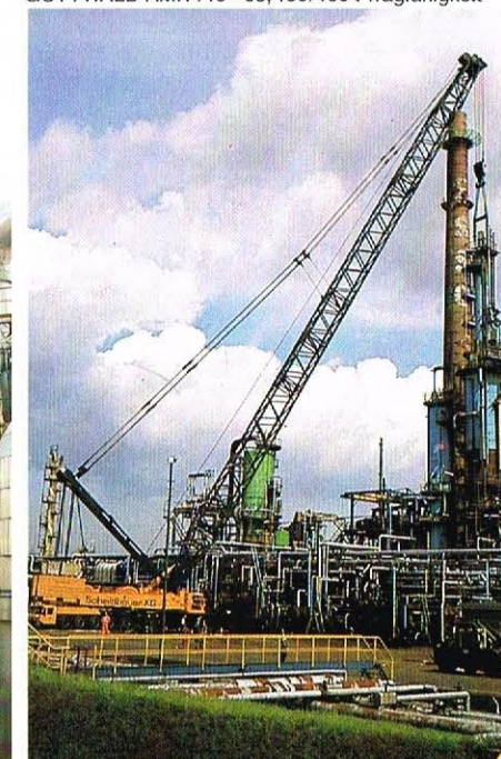
GOTTWALD AK 850, 800/850 t Tragfähigkeit
