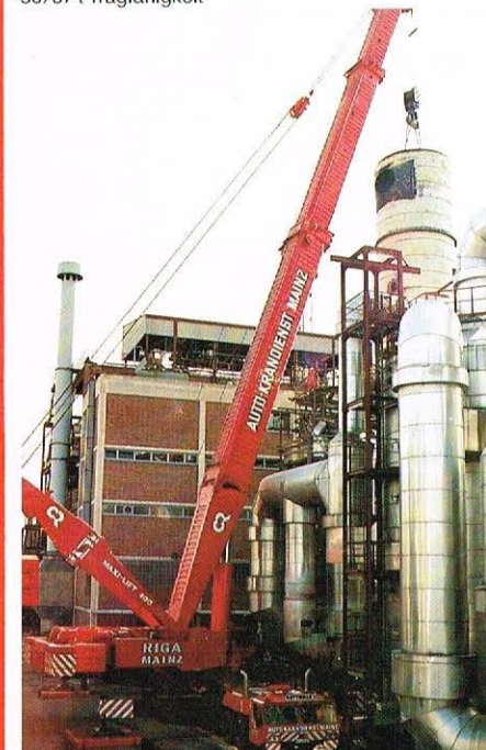
GOTTWALD AMK 400-93, 400/500 t Tragfähigkeit
