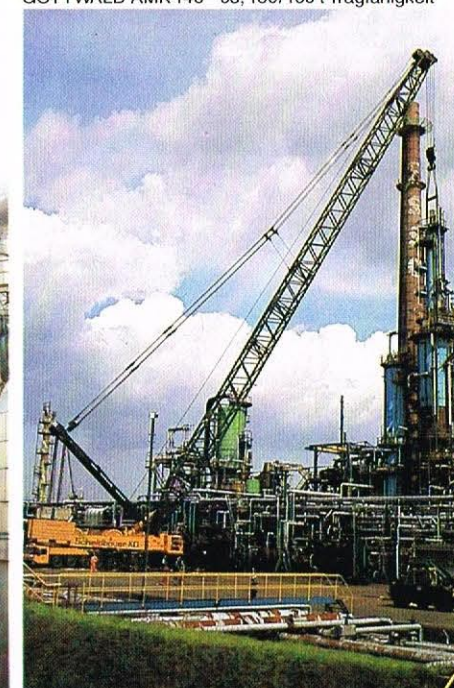
GOTTWALD AK 850, 800/850 t Tragfähigkeit
