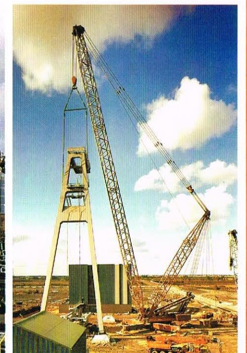
GOTTWALD AK 680, 650/850 t Tragfähigkeit
