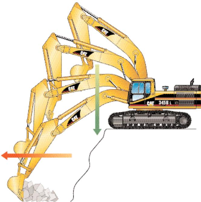
Das Beladen von Muldenkippern von einer erhöhten Standebene aus lässt sich mit der Schwimmfunktion deutlich produktiver und kraftstoffsparender bewerkstelligen, denn der Ausleger senkt sich beim Rückschwenken ohne zusätzlichen Hydraulikdruck aufgrund seines Eigengewicht selbsttätig ab.
