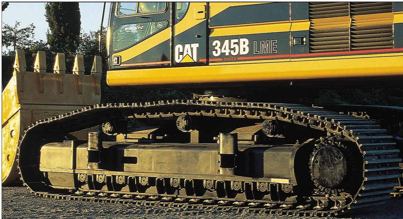
**Verstellbare Spurweite.** Der HD-Unterwagen mit H-förmigem Hauptrahmen und Spurverstellung bietet einerseits eine hohe Standsicherheit und erleichtert andererseits den Transport, denn mit 600-mm-Bodenplatten verringert sich die Breite bei eingefahrenen Laufrollenrahmen auf weniger als drei Meter. Für Einsätze auf unterschiedlichen Böden sind Normal- und Schwereinsatz-Bodenplatten in mehreren Breiten lieferbar.
