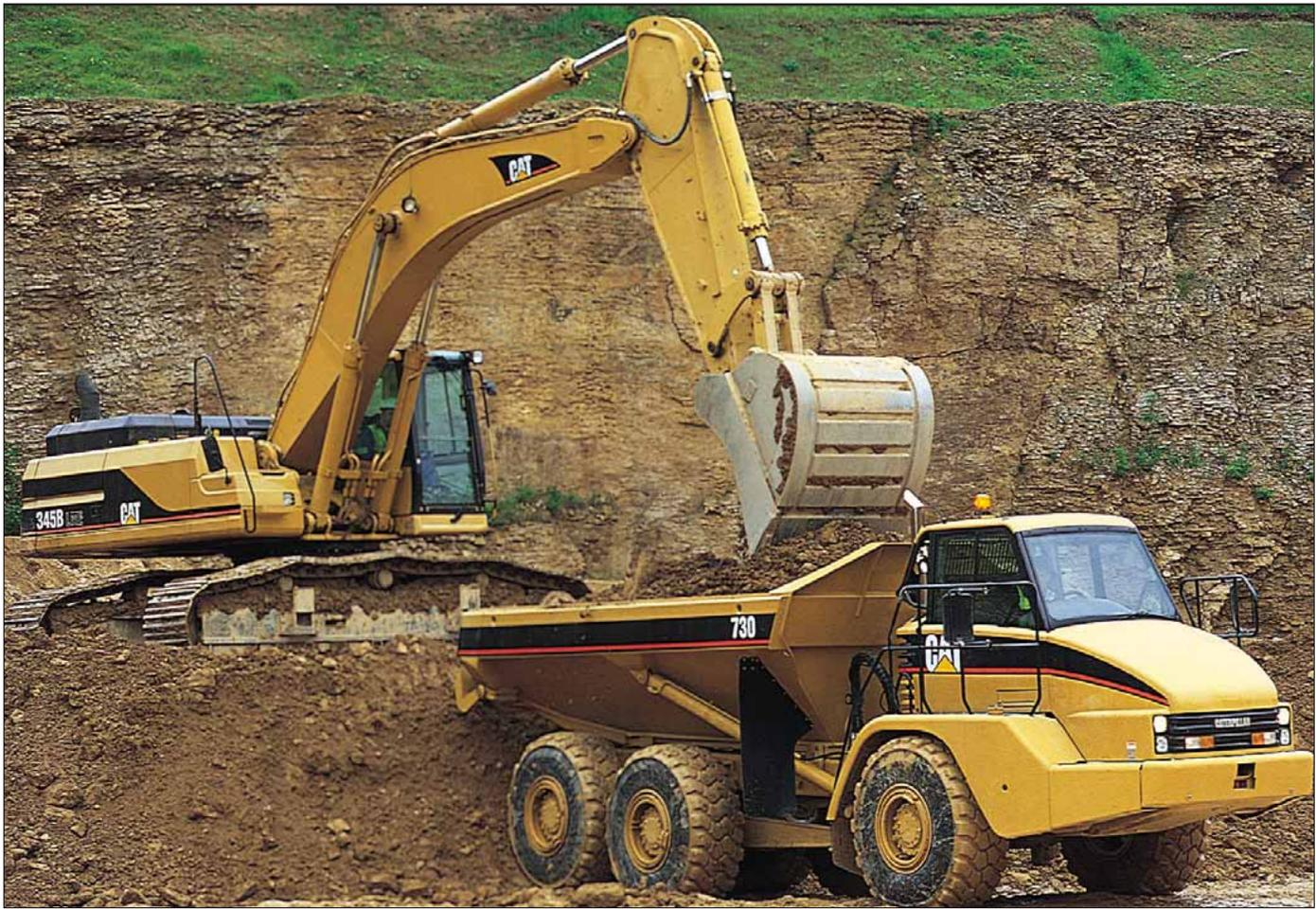
**Optimale Abstimmung.** Mit fünf bis sechs Ladespielen füllt der 345B-II die Kippmulde des Cat D350E in weniger als zwei Minuten. Im Team bieten diese beiden Maschinentypen eine maximale Lade- und Transportleistung bei niedrigsten Kosten pro Tonne.
