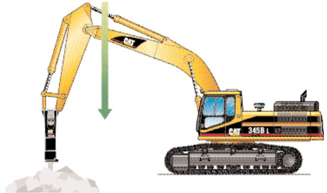
Bei Nutzung der Schwimmfunktion dringt der Hammer bereits durch das Eigengewicht der Arbeitsausrüstung (Ausleger, Stiel und Hammer) ohne zusätzliche Druckansteuerung in das Brechgut ein. So werden Fahrer und Maschine geschont und schädliche Hammerleerschläge vermieden. Ähnliche Vorteile ergeben sich beim Arbeiten mit Verdichterplatten.
