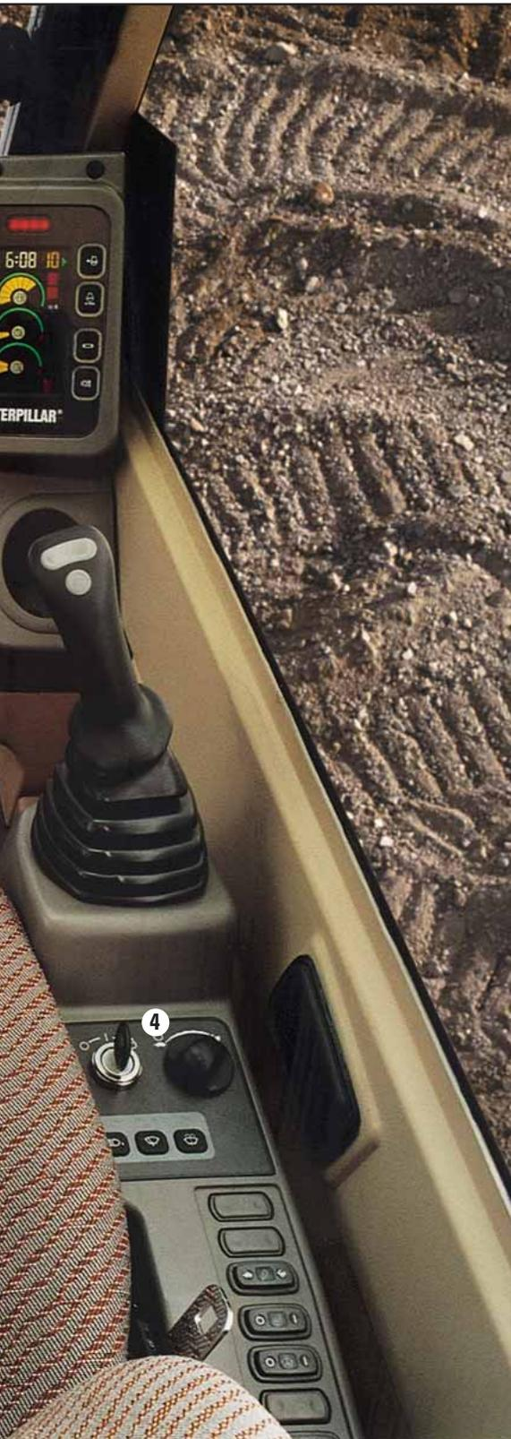
**Ergonomische Gestaltung.** Im Innenraum der Kabine dominieren Ergonomie und Komfort. Alle Bedienelemente befinden sich in direkter Reichweite des Fahrers und lassen sich mit geringem Kraftaufwand betätigen. Durch aufwendige technische Maßnahmen, z.B. die Befestigung der Kabine an Butylkautschuk-Elementen, wurden Lärm und Vibrationen auf ein Minimum reduziert.
