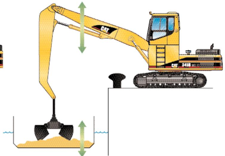
Auch beim Materialumschlag wirkt sich die Schwimmfunktion durch schnelleres Rückschwenken leistungssteigernd aus. Außerdem endet die Senkbewegung der Arbeitsausrüstung automatisch, sobald das Anbaugerät auf dem Ladegut aufliegt. Beim Löschen von Binnenschiffen macht die Arbeitsausrüstung die Schiffsbewegungen mit, ohne das Schiff nach unten zu drücken.
