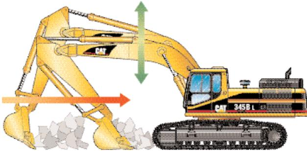
Arbeiten wie Steinkratzen und Feinplanieren werden durch *SmartBoom* wesentlich erleichtert, denn der Fahrer braucht sich nur auf die Stiel- und Löffelbewegungen zu konzentrieren, während der Ausleger der Bodenkontur frei folgen kann.
