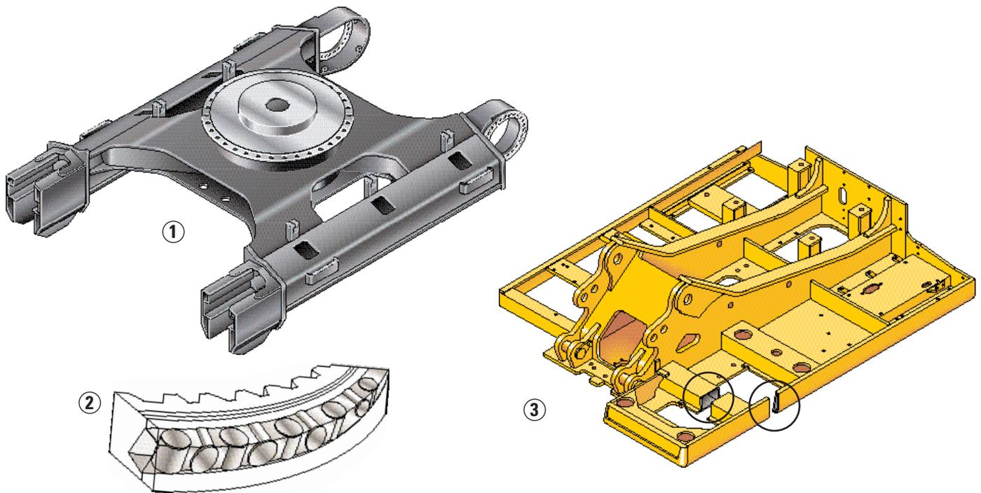
**1 Unterwagenrahmen** – Der in H-Form und aufwendiger Kastenprofil-Bauweise gefertigte Heavy-Duty-Rahmen des 345B-II wartet mit einer außergewöhnlichen Verwindungssteifigkeit auf.
