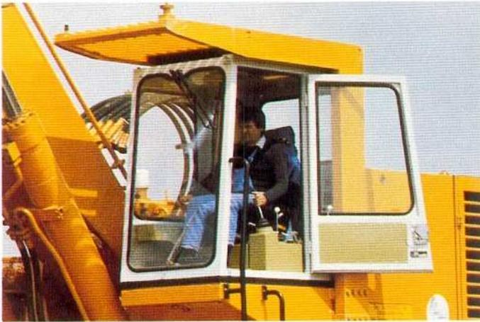
Der H 55 verfügt über eine geräumige und komfortable Fahrerkabine. Sie ist auf Gummischiene schwingungsarm gelagert und schalldämmend. Zur Ausstattung zählen:
