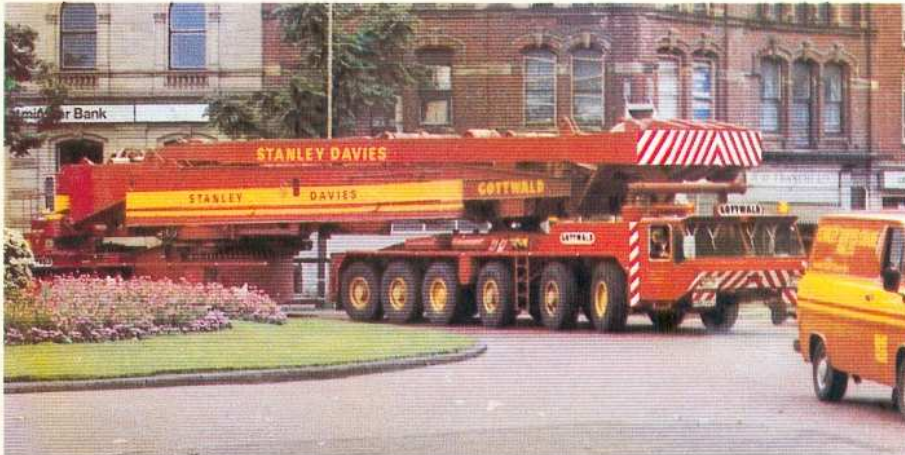
GOTTWALD AK 680 mit 650/850 t Tragfähigkeit
