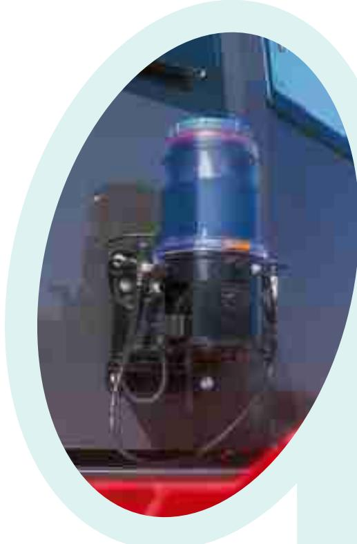
Impianto automatico di lubrificazione centralizzato (STD per ADT 35- ADT 40).
