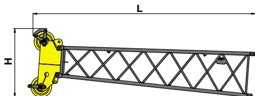
Ausleger - Kopfstück 6.1 m, Typ 1442 mit Rollenkopf T70 incl. Seile
