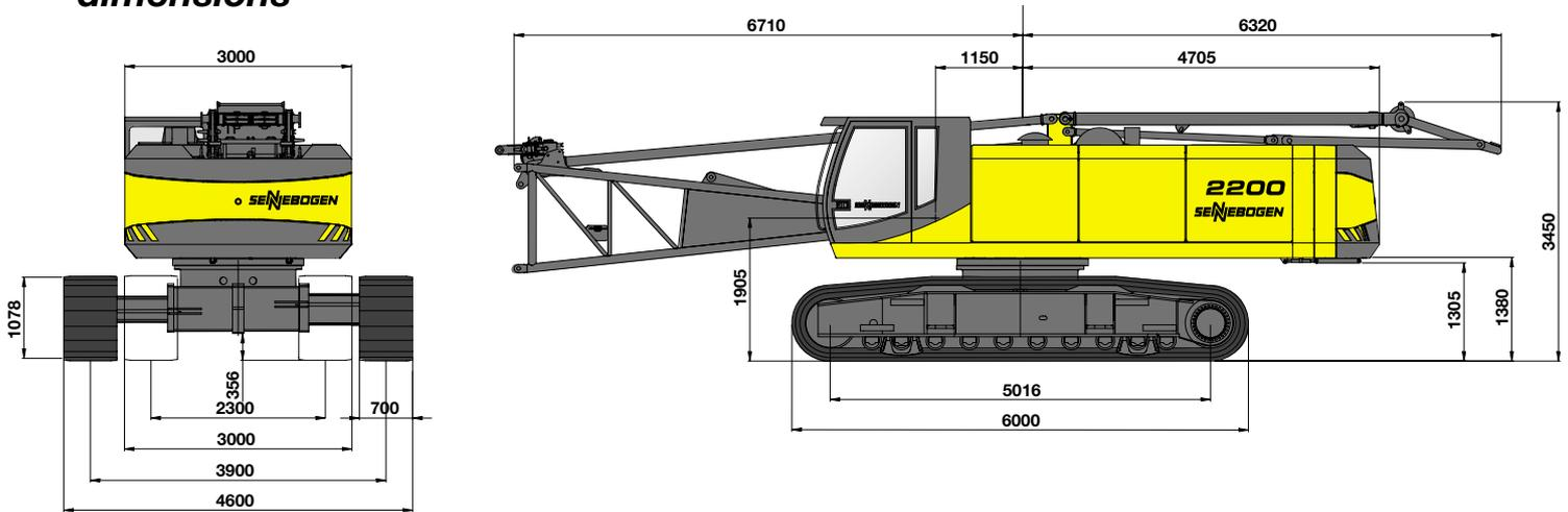
2200 mit Raupenlaufwerk B7 Länge 6000 mm - 2200 with crawler B7 length 6000 mm
