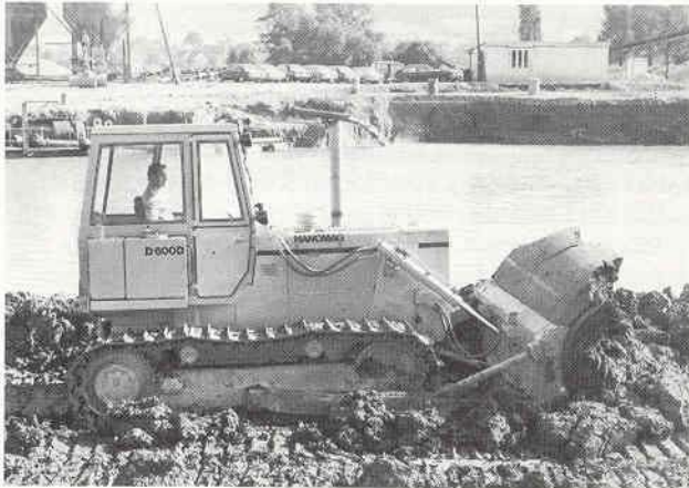
▲ Hohe Schubleistung durch neue Schildkontur und optimale Schubrahmenablenkung.
