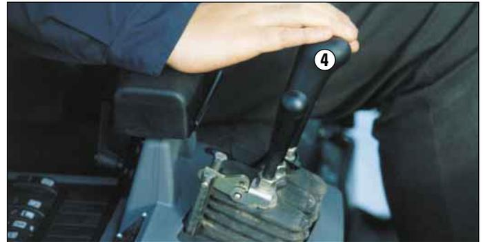
**Direktlenkung oder Normallenkung.** Der 966G ist mit zwei verschiedenen Lenksystemen lieferbar. Bei der Version mit Direktlenkung wird die Arbeitshydraulik mit einer elektrohydraulischen Vorsteuerung ausgerüstet, während Maschinen mit Normallenkung eine hydraulische Vorsteuerung besitzen.
