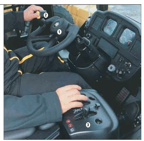
Schaltautomatik. Mit einem Drehschalter wird der manuelle oder automatische Schaltmodus gewählt. Im Automatikmodus kann der Fahrer mit diesem Schalter gleichzeitig festlegen, bis zu welchem Gang das Getriebe hochschaltet (zweiter, dritter oder vierter Gang). Abhängig vom gewählten Schaltprogramm wechselt das Getriebe die Gänge automatisch in optimaler Abstimmung auf Drehzahl, Drehmoment und Geschwindigkeit.
