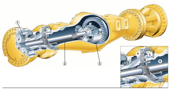
Achsen. Wegen der besonders hohen Belastungen in schweren Ladeeinsätzen sind die HD-Planetenachsen mit verstärkten Zahnrädern und Lagern in Differenzial und Nabengetrieben ausgestattet. Nach einer sorgfältigen Detailüberarbeitung konnte die Zahl der Einzelteile in den Getrieben deutlich verringert werden. Die dauergeschmierten Gelenke der Antriebswellen erfordern keinerlei Wartung.
