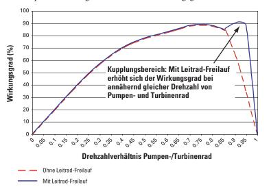
Drehmomentwandler. Der serienmäßige hydrodynamische Drehmomentwandler des 980G-II steigert das Drehmoment des Motors um ein Vielfaches und verhilft der Maschine dadurch zu einer überragenden Zugkraft am Felgenumfang. Optional kann der Wandler mit einem Leitrad-Freilauf ausgerüstet werden, der den Wirkungsgrad unter bestimmten Betriebsbedingungen verbessert und zugleich den Kraftstoffverbrauch reduziert.
