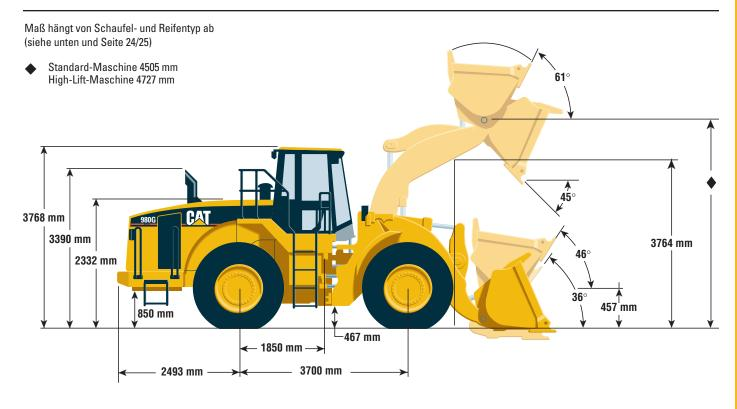
Spurweite bei Bereifung 29.5-25 – 2440 mm Spurweite bei Bereifung 26.5-25 – 2368 mm
