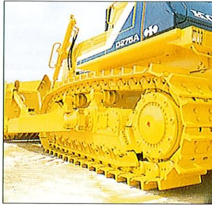
**Einzigartige Modulbauweise erlaubt Bauteile des Antriebsstranges ohne Ölverlust aus – bzw. einzubauen**
