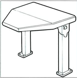
**ROPS-CANOPY** gemäß ISO 3471 und SAE J1040 (APR 88) für ROPS, sowie gemäß ISO 3449 für FOPS.
