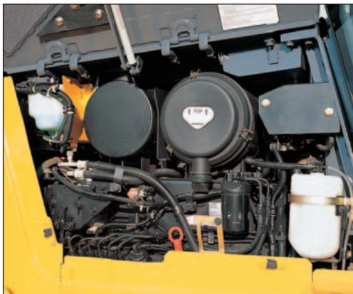
Ein Kühlwasser-Ausgleichsbehälter erleichtert die Kühlwasserstandkontrolle und vermeidet häufiges Nachfüllen.
