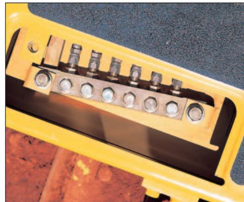
Die Öldruckprüfanschlüsse für den Antriebsstrang sind zentral zusammengefasst und leicht zugänglich auf der rechten Seite der Kabinenplattform angeordnet.
