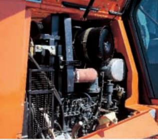
**Das Ölablassen**Das Ölablassen erfolgt über eine Schlauchverbindung von der Ölwanne zum unteren Bodenpanzer.
