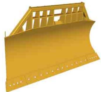
**Forstschild.** Am Forstschild ist ein zusätzliches Schutzgitter angebracht, um Beschädigungen der Maschine durch Baumstämme zu verhindern. Außerdem wurde die Blechdicke des Schildkörpers an die höheren Belastungen in der Forstwirtschaft angepasst.
