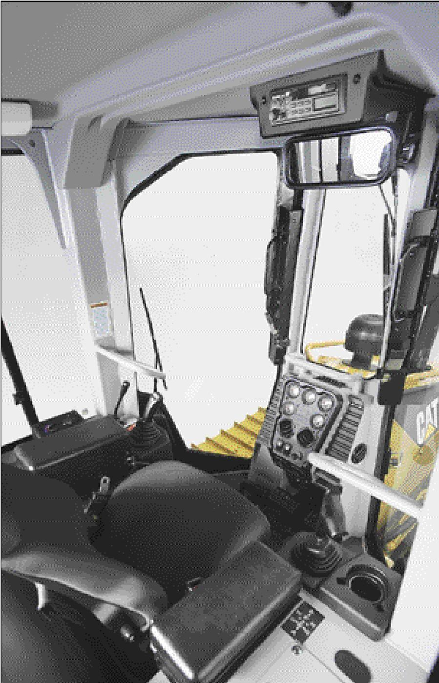
**Fahrercomfort.** Bei der umfassenden Kabinen-Überarbeitung dienten die größeren Caterpillar Kettendozer als Vorbild. So ist die neue Kabine der G-Serie nicht nur deutlich geräumiger, sondern auch ergonomischer geworden. Serienmäßige Klimaanlage und verbesserte Sichtverhältnisse sind weitere Kabinenmerkmale, die dem Fahrer ein ermüdungsarmes und produktives Arbeiten gestatten.
