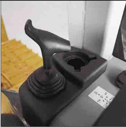
**Schildsteuerung.** Sämtliche Funktionen des hydraulisch heb-, kipp- und schwenkbaren VPAT-Schildes lassen sich mit einem ergonomisch gestalteten Hebel feinfühlig ansteuern, sodass der Fahrer zum Beispiel problemlos ein sauberes Feinplanum herstellen kann.
