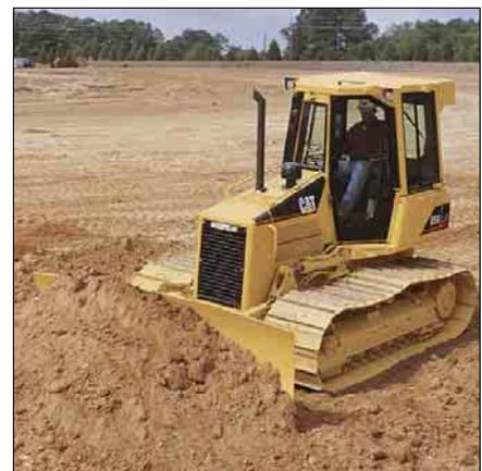
**Vielseitigkeit.** Zur Standardausrüstung gehört ein robust konstruierter, universeller VPAT-Schild, der sich hydraulisch heben, schwenken und kippen lässt. Dieser Schild ist speziell für folgende Arbeiten vorgesehen: Feinplanierung, Schneiden und Rückverfüllen von Gräben, Erstellen von Streifhaufen, Materialverteilung, Landschaftsbau, mittelschwere Rodungen und schweres Abschieben.
