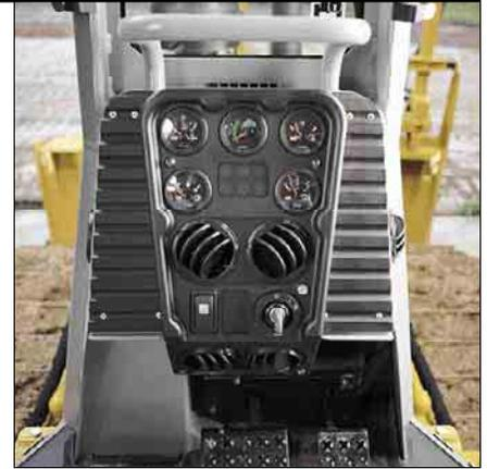
**Instrumentierung.** Im Instrumententräger, der direkt vor dem Fahrer angeordnet ist, befinden sich fünf gut ablesbare Anzeigen für Kraftstoffvorrat, Motoröldruck, Kühlwassertemperatur, Hydrogetriebeöltemperatur und Höchstgeschwindigkeitseinstellung. Außerdem sind fünf Kontrollleuchten vorhanden:
