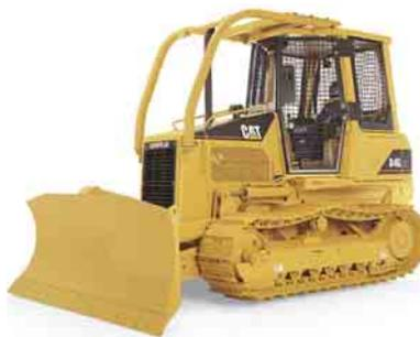
**Schutzvorrichtungen.** Die Fahrerkabine ist auf Wunsch mit einem Rundum-Schutzgitter lieferbar. Anstelle der normalen Fensterscheiben können die Türen mit durchschlagsicherem Lexan-Glas ausgerüstet werden.
