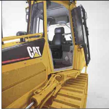
**Ein- und Ausstieg.** Sechseckige Kabinenform, schräg angeordnete Türen und mühelos erreichbare Türgriffe tragen maßgeblich zum einfachen, sicheren Ein- und Aussteigen bei.
