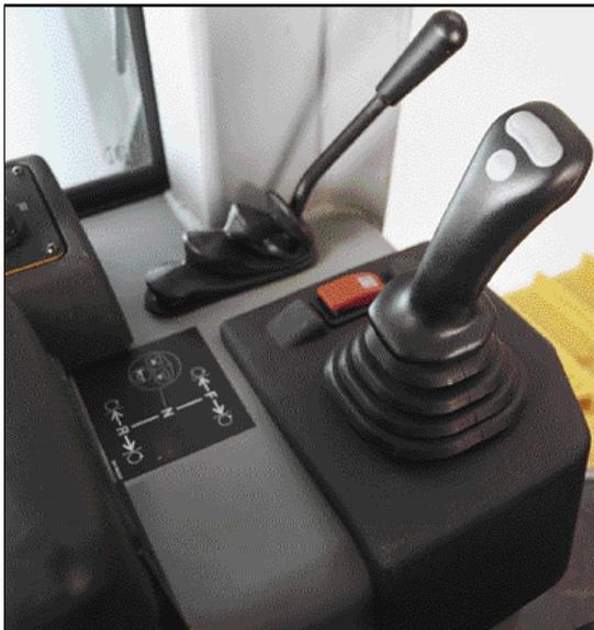
**Bedienbarkeit.** Gegenüber den Vorgängermaschinen wurde die Bedienung des hydrostatischen Fahrtriebs der G-Serie weiter vereinfacht. Dadurch kann sich der Fahrer vorwiegend auf das Steuern der Arbeitsausrüstung konzentrieren.
