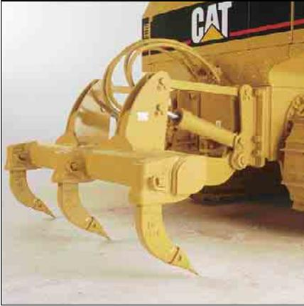
**Aufreißer.** Der neue Parallelogramm-Heckaufreißer wurde vergrößert und verstärkt, um die Reißleistung zu erhöhen. Außerdem können dank längerer Zähne größere Reißtiefen erzielt werden, sodass sich die Produktivität merklich steigert.
