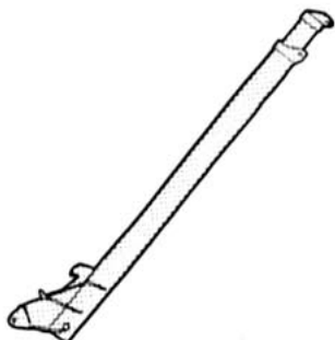
Kranarm* hydrauliskt utskjutbar 1,2 m.
