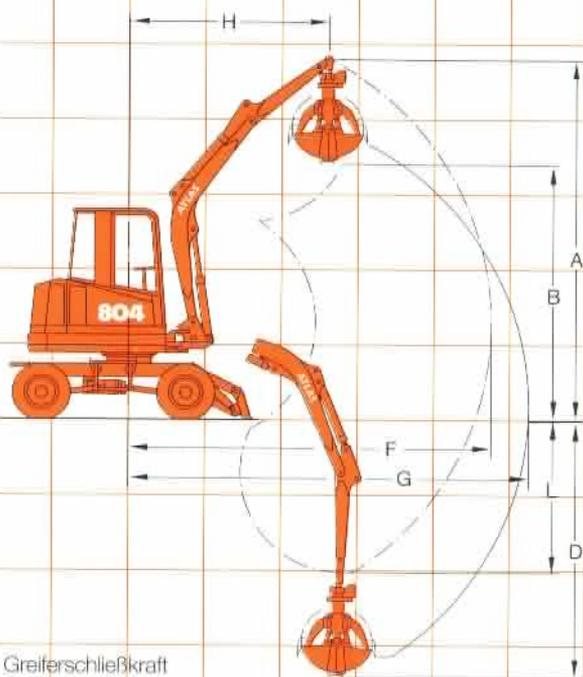
Greiferschließkraft max. 24,0 kN
