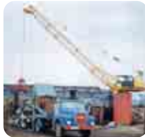
1970 Vollhydraulischer Seilbagger als stationäre Umschlagmaschine Fully hydraulic rope excavator as pedestal handling machine
