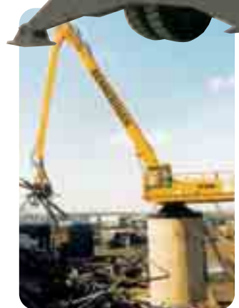
1986 Innovation: Für den stationären Materialumschlag entwickelt SENNEBOGEN extrem lange Ausleger für 20 m Reichweite. Eine echte Pionierleistung die die Entwicklung maß- geblich beeinflusst.
