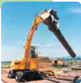
1978 Holzumschlag in Sibirien / CIS (Ust Ilimsk) Tiefsttemperaturen bis -40°C, erhöhte Kabine, fester spezial Holzgreifer Timber handling in Siberia / CIS (Ust Ilimsk) Deep temperature use up to -40°C High cab, special timber grab
