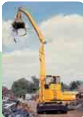
1979 Innovation: 24 t Mobilumschlaggerät, Reichweite 12,5 m, Spezial-SENNEBOGEN Achsen mit 3 m Breite für exzellente Stabilität. Innovation: SENNEBOGEN wide gauge-axes 3 m width for excellent stability 24 t mobile handling machine 12,5 m action radius
