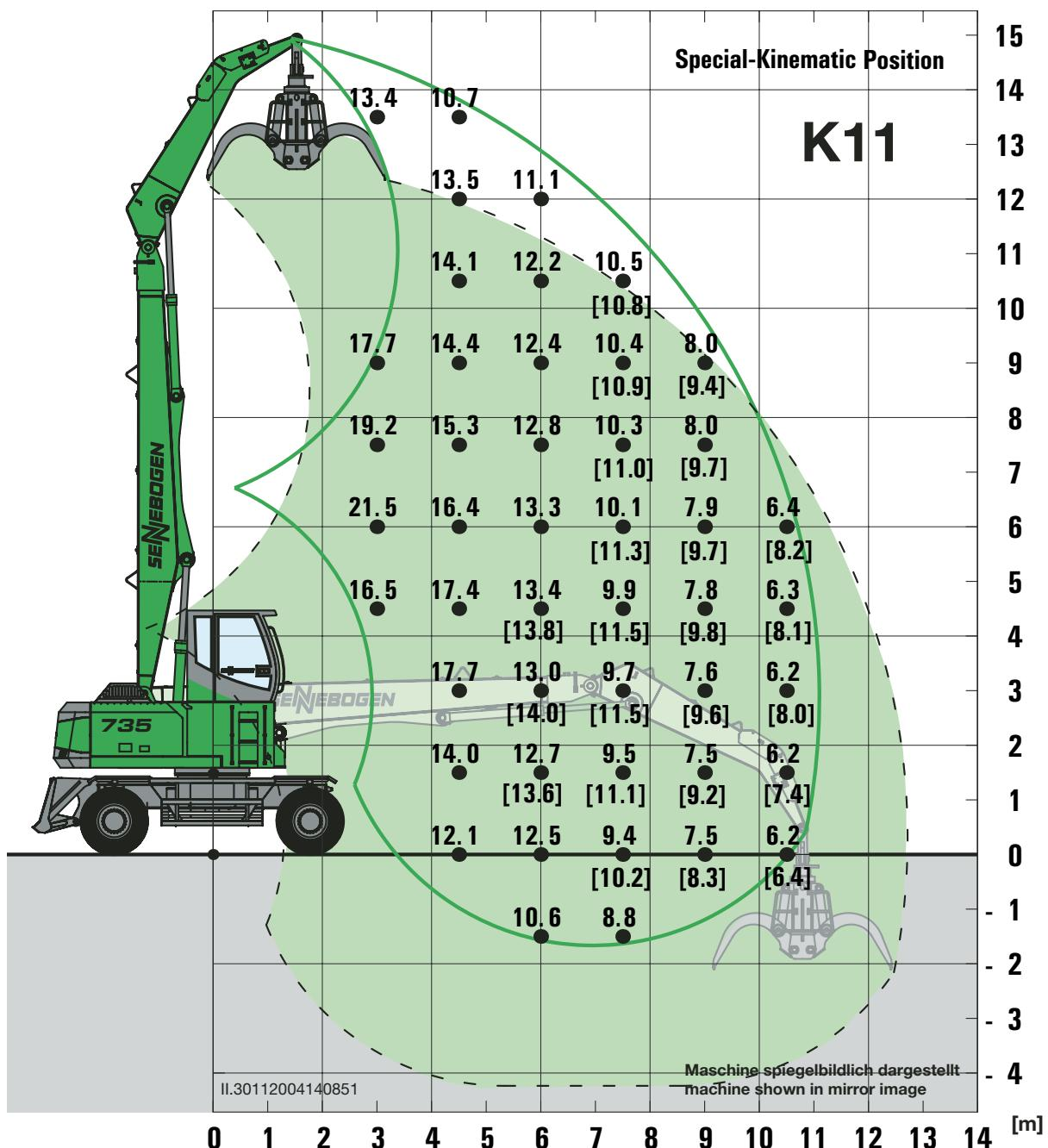
**735 M-HD die besondere Holz-Umschlagmaschine**
