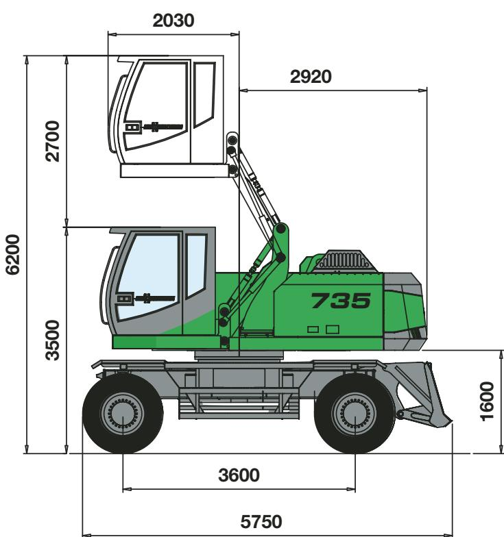
**735 M-HD** mit hydraulisch um 2700 mm hochfahrbarer Kabine Typ C 270
