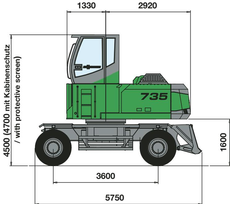
**735 M-HD** mit starr hochgesetzter Kabine, Erhöhung 1000 mm,
