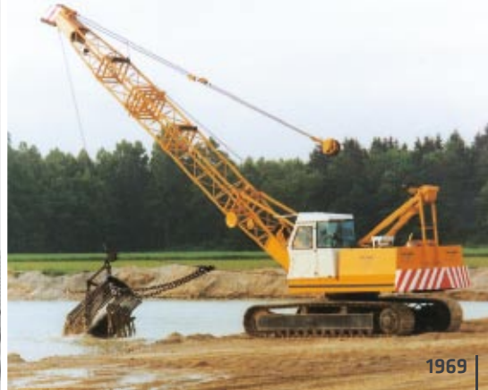
weltweit erster vollhydraulischer Seilbagger
