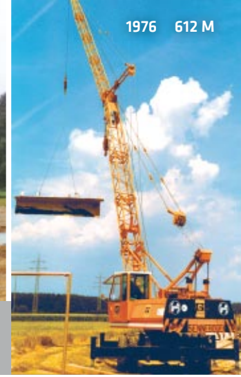
weltweit erster vollhydraulischer Seilbagger
