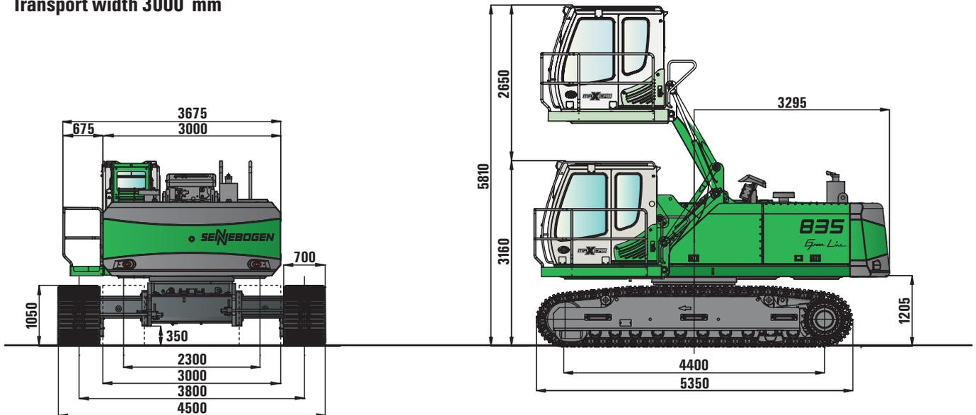
835 R mit hydr. teleskopierbarem Unterwagen T41/380 und hydraulisch hochfahrbarer Kabine Typ D270
