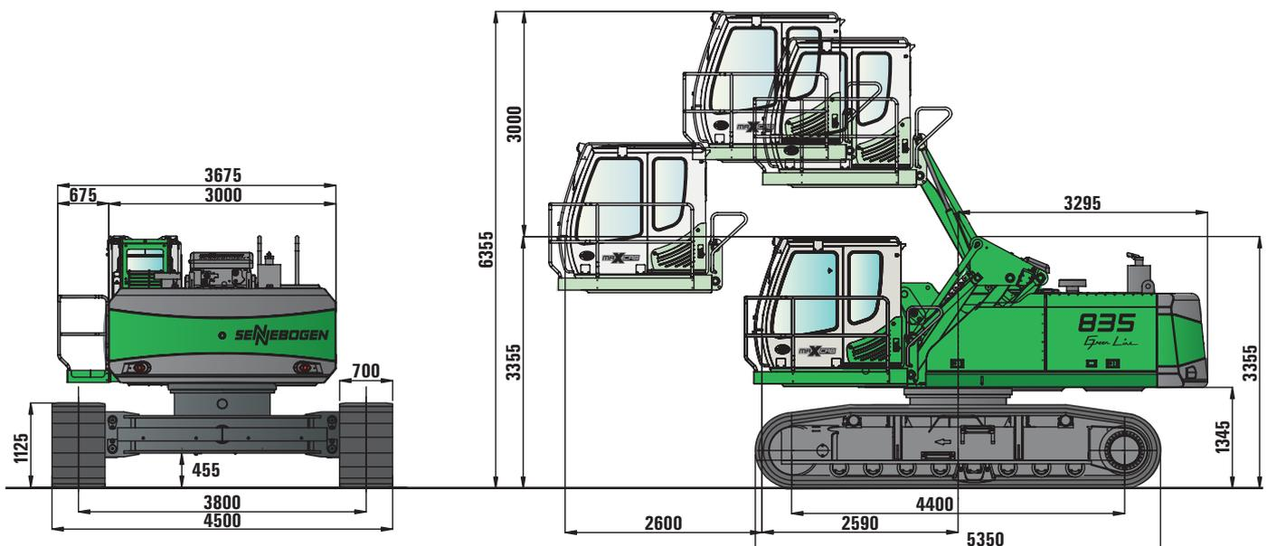
835 R mit Breitspurunterwagen R44D/380 und hydraulisch hoch- und vorfahrbarer Kabine Typ D300/260
