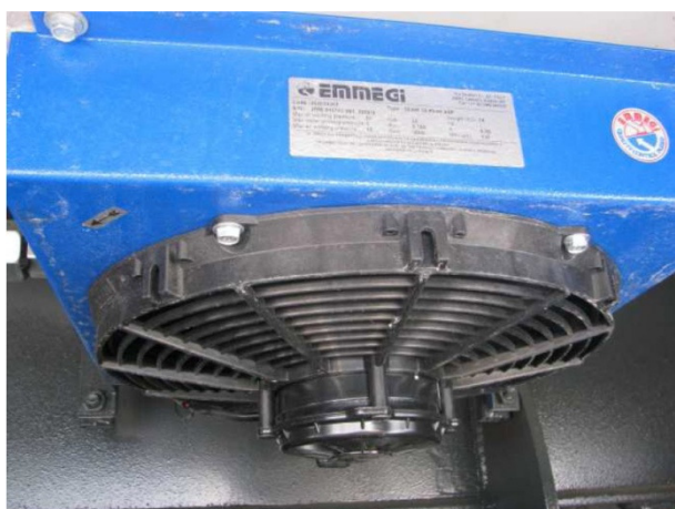
Podwójna chłodnica oleju, utrzymująca jego stałą temperaturę.
