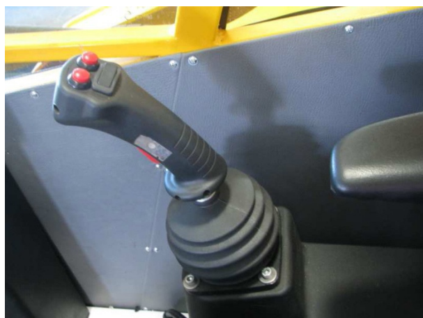
Sterowanie proporcjonalne za pomocą sterownika wielofunkcyjnego (joystick).
