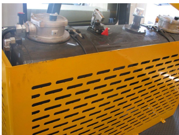
Zbiornik oleju hydraulicznego.
