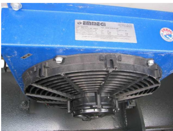
Podwójna chłodnica oleju, utrzymująca jego stałą temperaturę.
