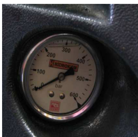
Czujniki ciśnienia oleju hydraulicznego w kabinie operatora.
