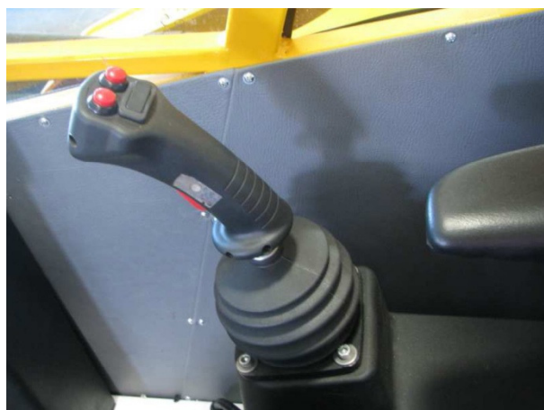
Sterowanie proporcjonalne za pomocą sterownika wielofunkcyjnego (joystick).
