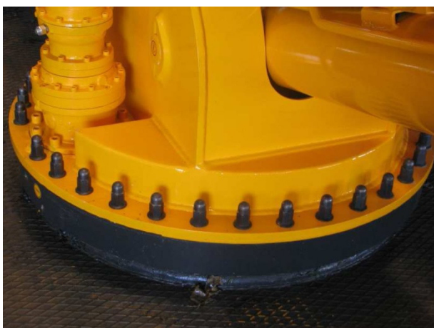
Obrotnica, pozwalająca na nieograniczony obrót teleskopu dookoła osi.
