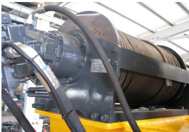
Hydrauliczna wciągarka liny.
