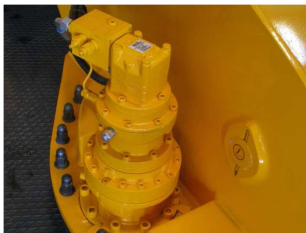
Obrotnica, pozwalająca na nieograniczony obrót teleskopu dookoła osi.
