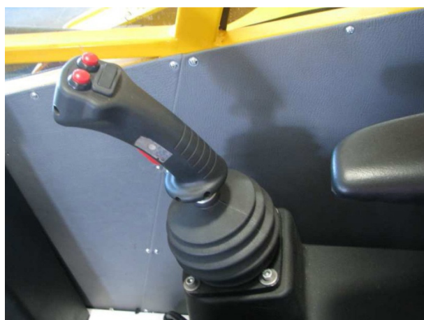
Sterowanie proporcjonalne za pomocą sterownika wielofunkcyjnego (joystick).
