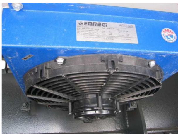
Podwójna chłodnica oleju, utrzymująca jego stałą temperaturę. Możliwość zamontowania pakietu zimowego (opcja) – grzałka oleju oraz system izolacji przewodów hydraulicznych.
