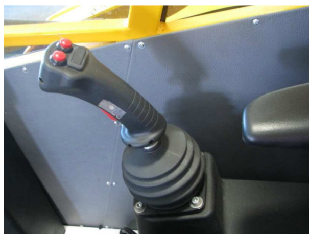
Sterowanie proporcjonalne za pomocą sterownika wielofunkcyjnego (joystick).
