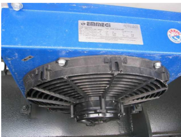
Podwójna chłodnica oleju, utrzymująca jego stałą temperaturę. Możliwość zamontowania pakietu zimowego (opcja) – grzałka oleju oraz system izolacji przewodów hydraulicznych.
