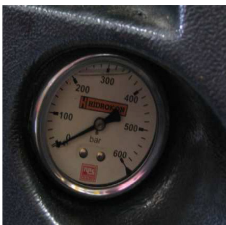
Czujniki ciśnienia oleju hydraulicznego w kabinie operatora.
