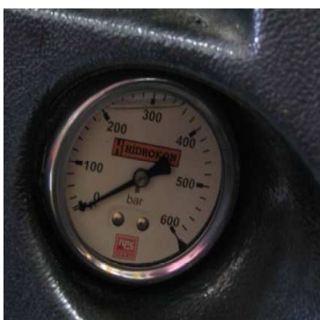
Czujniki ciśnienia oleju hydraulicznego w kabinie operatora.
