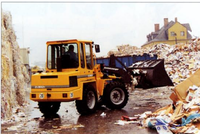
Leichtgutschaufel mit großem Volumen - ausgeschäumte Reifen.
