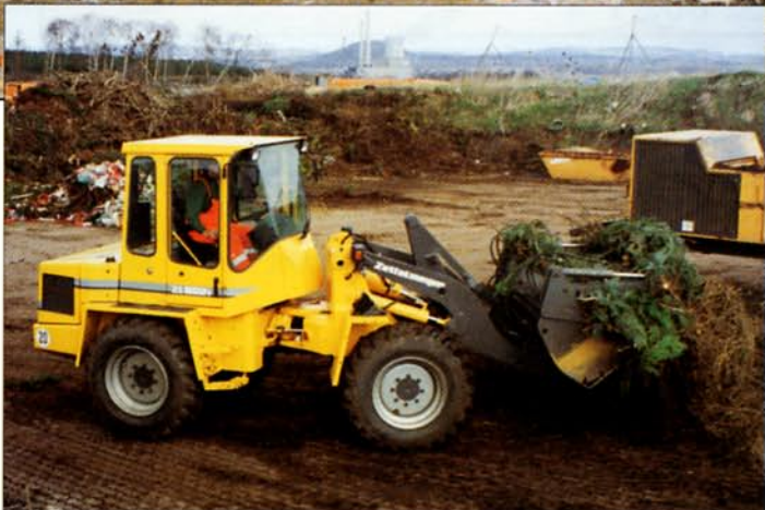
Spezial-Greifschaufel zur Beschickung von Kompostierungsanlagen
