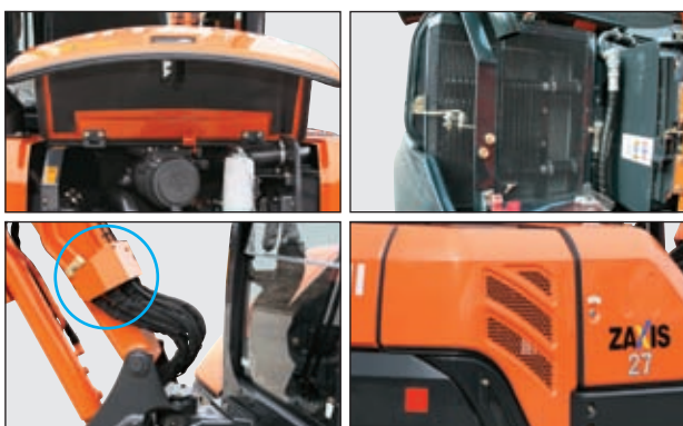
Hydraulische slangen met snelkoppelingen
