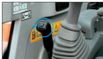
Bladhendel met schakelaar voor tweede rijsnelheid
