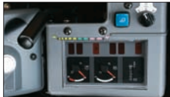
Bladhendel met schakelaar voor tweede rijsnelheid
